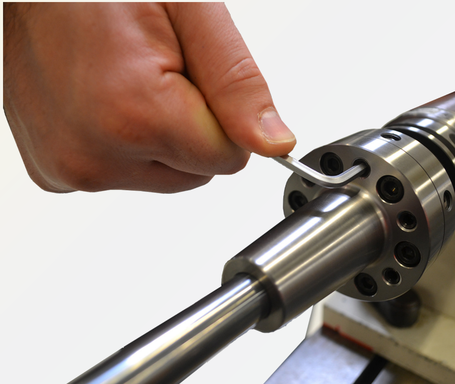
Abb. 17: Winkel mit den Winkeleinstellschrauben ausrichten
