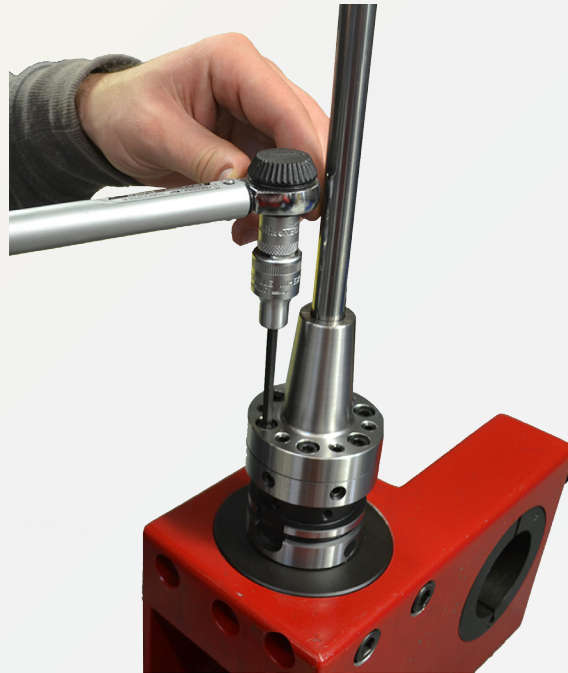
Abb. 7: Befestigungsschrauben mit Drehmoment anziehen
