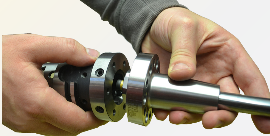
Abb. 5: Modul Flansch in den Modul Ausrichtadapter einpassen
