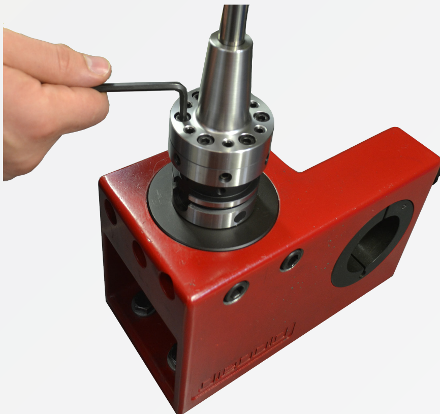
Abb. 6: Befestigungsschrauben leicht anziehen
