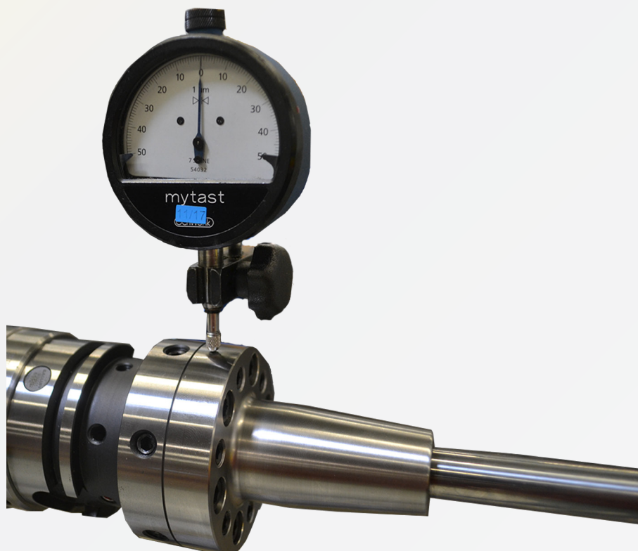
Abb. 8: Messuhr an der Rundlaufkontrollstelle in Position bringen
