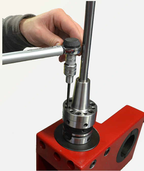
Abb. 12: Befestigungsschrauben mit Drehmoment anziehen
